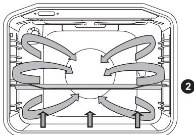
Одновременно работают нижний нагревательный элемент, нагревательный элемент вокруг вентилятора и вентилятор.
