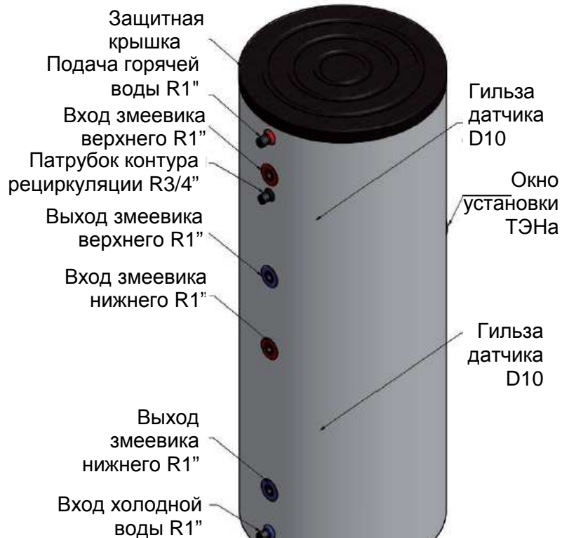
Водонагреватель с двумя теплообменниками-змеевиками 160-200 л
