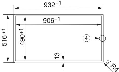
④ Ступенчатая фрезеровка
