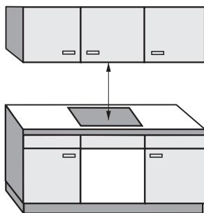
Необходимо соблюдать указанное производителем вытяжки безопасное расстояние между панелью конфорок и расположенной сверху вытяжкой. Если указания производителя вытяжки отсутствуют или над прибором монтируются навесные полки из легко воспламеняющихся материалов, то необходимо соблюдать безопасное расстояние минимум 760 мм.
