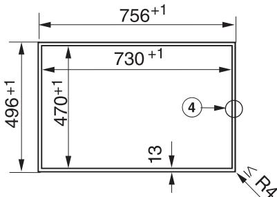
④ Ступенчатая фрезеровка
