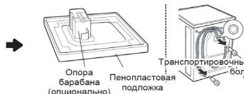
Снимите транспортировочные болты и опоры.
