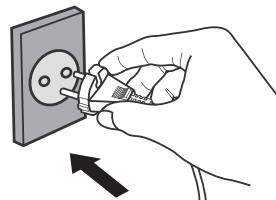
■ Поскольку датчик запаха определяет текущую степень чистоты после вставки вилки в розетку, как стандартную, рекомендуется вставлять вилку в розетку, когда воздух чистый (когда отсутствует сигаретный дым). (Стандартное состояние датчика запаха автоматически обновляется в соответствии со степенью чистоты в помещении).
