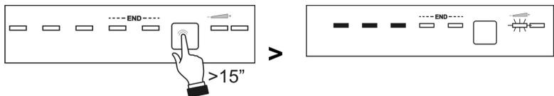
После выполненной регулировки или отображения настройки достаточно не нажимать кнопку несколько секунд, после чего посудомоечная машина автоматически вернется в обычное состояние, выйдя из режима регулировки.
