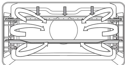
Одновременно работают верхний нагревательный элемент, инфранигреватель и вентилятор.
