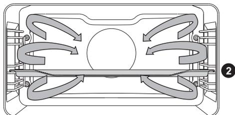
Одновременно работают нагревательный элемент вокруг вентилятора и вентилятор. Вентилятор создает постоянную циркуляцию горячего воздуха вокруг мяса или выпечки.
