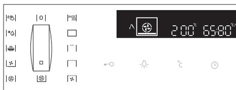
**3** Поверните ПЕРЕКЛЮЧАТЕЛЬ РЕЖИМА НАГРЕВА (нагрев снизу + вентиляционный нагрев). На дисплее высветятся символ, предустановленная температура, температура зонда и установленная температура. Нажмите на сенсор СТАРТ/СТОП.
