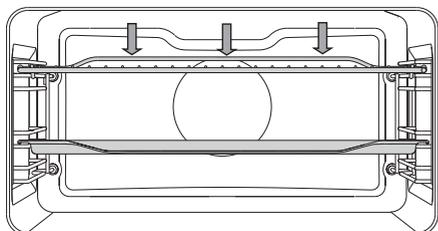
При **большом гриле** включаются верхний нагревательный элемент и инфранигреватель, расположенные под потолком духовки.
