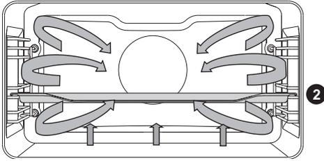
Одновременно работают нижний нагревательный элемент, нагревательный элемент вокруг вентилятора и вентилятор.
