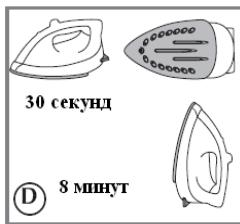
Үтікті автоматты сөндіру функциясы келесідей тәсілмен жүзеге асады: Белгілі бір температураға дейін қыздырылған, бірақ, қолданылмаған үтік, сондай-ақ, табанында жатқан немесе бір қырынан жатқан үтік 30 секундтан кейін автоматты түрде сөнеді. Егер үтік пайдаланылмаса және таяныштіректі тігінен тұрса, - автоматты түрде сөну режимі 8 минуттан кейін қосылады ( D сурет). Үтіктің автоматты отключение қызбаның индикатора жылтынымен және дыбысты құлақтандыр- (6) қоса беріледі.
