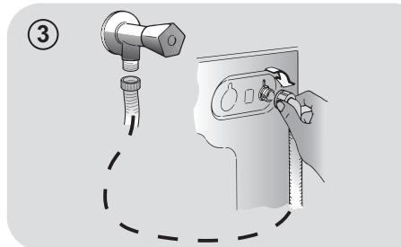
● **AQUASTOP (ПРЕКРАЩЕНИЕ ПОДАЧИ ВОДЫ)** (рис. 5): В шланге подачи воды установлено устройство, которое при повреждении шланга прекращает подачу воды в машину; в этом случае в окне "A" появляется красная метка, что указывает на то, что шланг нужно заменить. Чтобы отвернуть гайку, нужно нажать на фиксатор "B".
