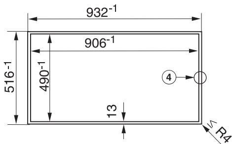
④ Ступенчатая фрезеровка
