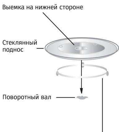
На поворотную ось устанавливается стеклянный поднос. Под стеклянный поднос устанавливается роликовая подставка, которая помогает подносу свободно вращаться. Вращение пищи во время работы печи способствует ее равномерному приготовлению.
