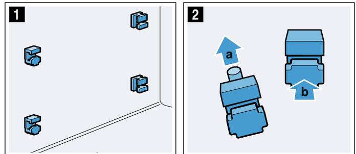
3. Установите крючок заднего держателя в верхнее отверстие **a** и вставьте держатель в нижнее отверстие **b** (рис. **3**).
